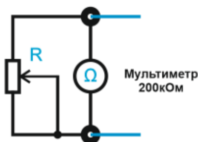
Рисунок 26 – Схема подключения мультиметра для исследования резистивного датчика линейного перемещения.
