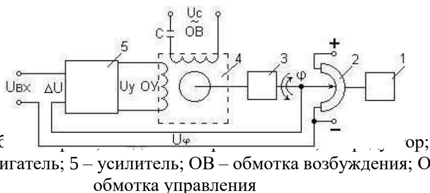
Рисунок 4 – Схема управления исполнительным механизмом с использованием датчика обратной связи
